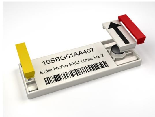
*Das FP Thermo-UV-Sign - individuell zu beschriften, besonders haltbar und UV-stabil, mit durchgefärbter Mediumkennzeichnung entsprechend DIN 2403 und durchgefärbten Fließrichtungspfeil. Optional mit einem RFID-Transponder zu bestücken.*
